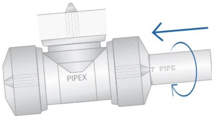
۷. لوله را در جهت عکس بیرون کشیده تا از درگیر شدن لوله داخل هزارخار اتصال مطمئن شویم.
