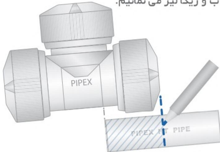
۶. لوله را تا محل علامت زده شده در راستای محور ورود به اتصال با کمی چرخش وارد کرده ( به طوریکه علامت ماژیک قابل دیدن نباشد) تا لوله و اتصال تحت فشار دراز مدت از هم جدا نشوند.
